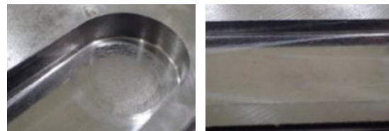
突込み → 横引き Plunging → Horizontal Milling
