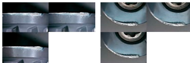
29m 加工後のインサートの写真 After 29m of milling
