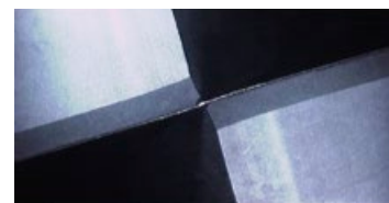
加工終了後の刃先の状態 Cutting edge after milling
