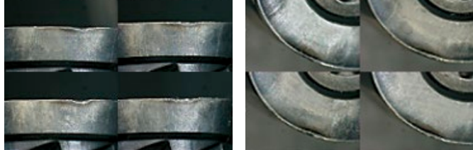
67.2m加工後のインサートの写真 After 67.2m of milling
