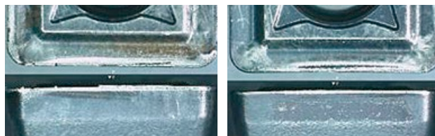
インサート摩耗幅の写真(5穴加工時点) Photo of insert wear width (after 5 holes)
