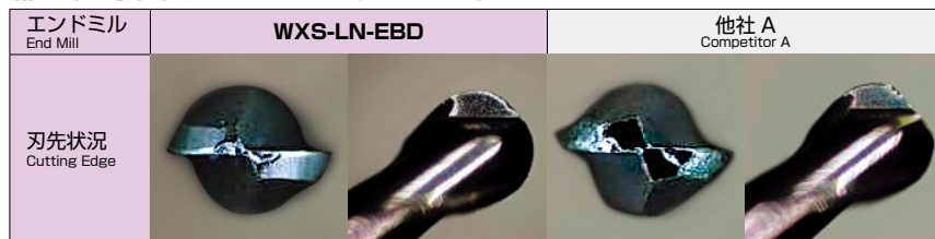
加工時の摩耗状況 Tool wear after pocket milling
