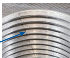
タップによる加工 Processing by tap
