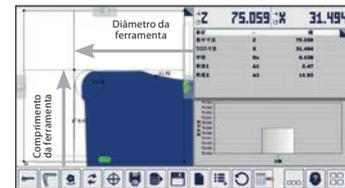
O comprimento, diâmetro, raio e ângulo de uma ferramenta podem ser medidos simultaneamente ao toque de um botão.
