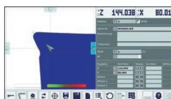
A OZT identifica o número de facas e a geometria da ferramenta para medi-las simultaneamente. Os valores medidos do batimento axial e radial serão exibidos em lista, facilitando a identificação do corte divergente.
