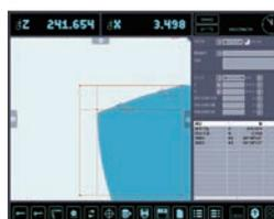
Diversos pontos para medição podem ser registrados previamente. As posições da ferramenta a serem medidas são organizadas em lista no painel, facilitando seu gerenciamento. A altura da aresta de corte, assim como o diâmetro, podem ser gerenciados com a sua tolerância.
