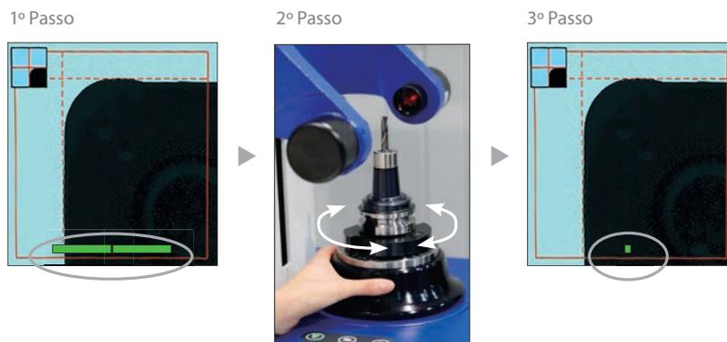
A barra no canto inferior da tela indica o ajuste do foco de acordo com o giro do mandril.
