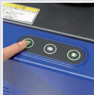
Fixação a vácuo, freio de fuso e fixação do fuso 4 X a 90°.
