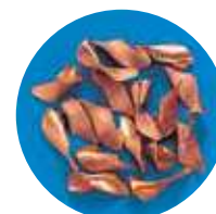
C1020 EX-SUS-GDR ø 8,5 Velocidad: 32 m/min. Avance: 0,24 mm/rot.
