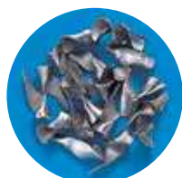
SUS304 EX-SUS-GDR ø 8,5 Velocidade: 18 m/min. Avanço: 0,2 mm/rot.
