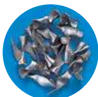
SUS304 EX-SUS-GDR ø 8,5 Velocidad: 18 m/min. Avance: 0,2 mm/rot.
