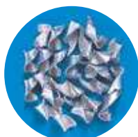
A7075 EX-SUS-GDR ø 8,5 Velocidad: 50 m/min. Avance: 0,45 mm/rot.
