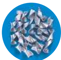
A7075 EX-SUS-GDR ø 8,5 Velocidade: 50 m/min. Avanço: 0,45 mm/rot.
