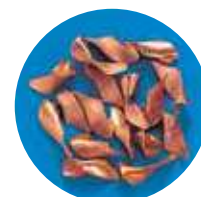
C1020 EX-SUS-GDR ø 8,5 Velocidade: 32 m/min. Avanço: 0,24 mm/rot.
