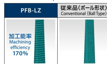
■ 工具軌跡の違い Difference in tool path
