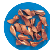
C1020 EX-SUS-GDR ø 8,5 Velocidad: 32 m/min. Avance: 0,24 mm/rot.
