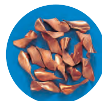
C1020 EX-SUS-GDR ø 8,5 Velocidade: 32 m/min. Avanço: 0,24 mm/rot.
