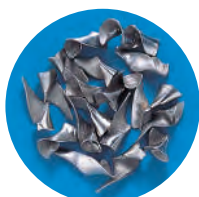
SUS304 EX-SUS-GDR ø 8,5 Velocidade: 18 m/min. Avanço: 0,2 mm/rot.
