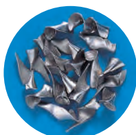
SUS304 EX-SUS-GDR ø 8,5 Velocidad: 18 m/min. Avance: 0,2 mm/rot.
