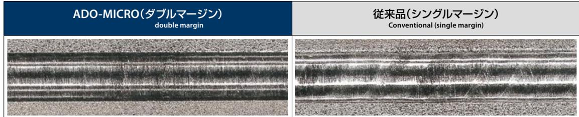
使用工具: ADO-MICRO 20D φ2    被削材: SUS304    加工深さ: 40mm
