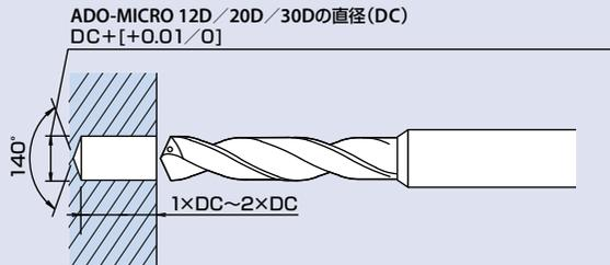
★湾曲部を加工の際は、ガイド穴加工前に座ぐり加工用エンドミル FX-ZDS、超硬フラットドリル ADFにて座ぐり加工を行って下さい。
